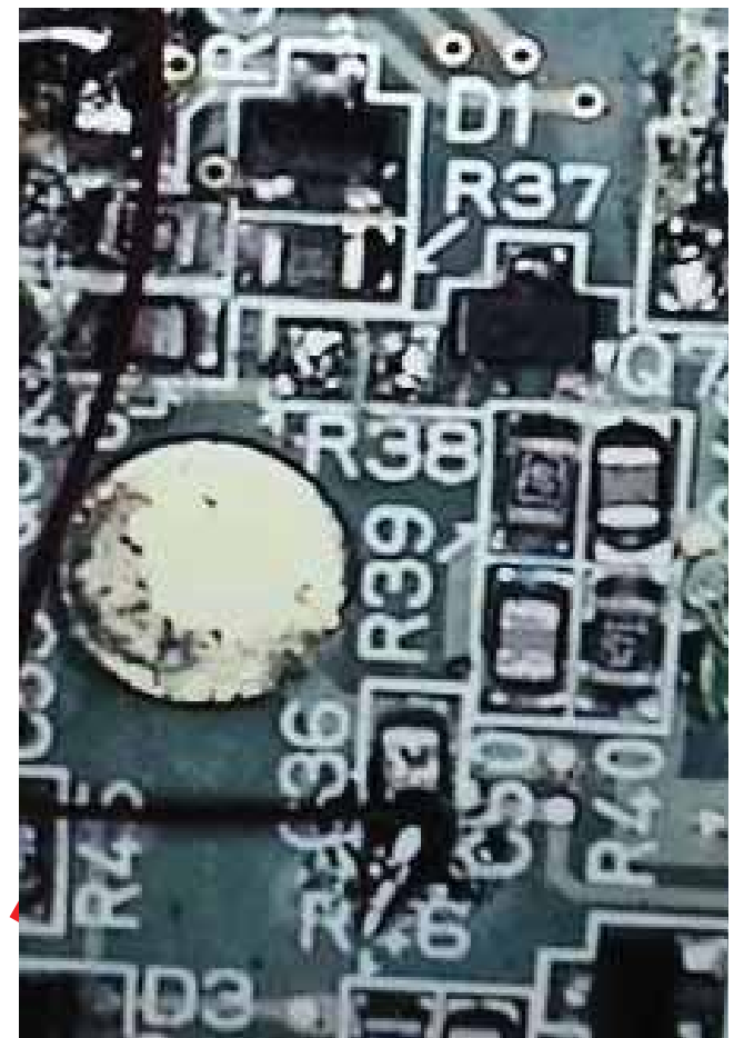
C36 に電線をはんだづけ
