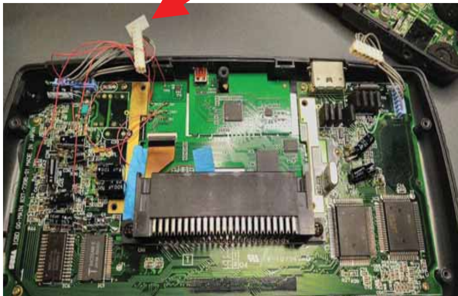
GG kitのTP0から伸びる電線と、その先の銅膜
