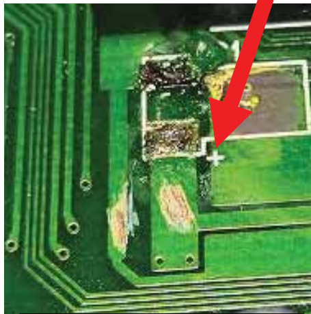
ソルダレジストを削って 銅線を露出させる
