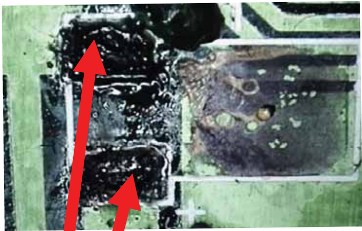
腐蝕したランド
