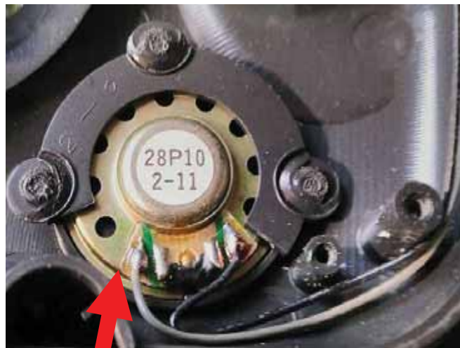
スピーカーにはんだづけされた 2本の電線
