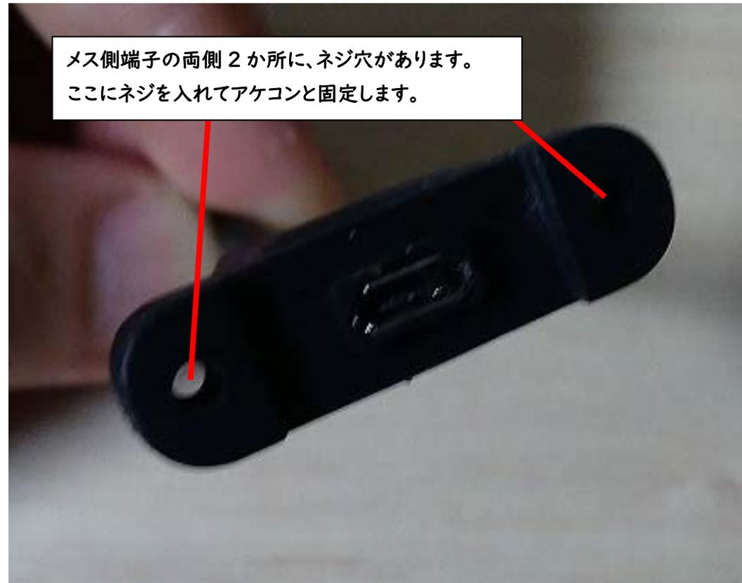
左写真の MicroUSB オス側の端子(下)を途中で切れば、4 本の線 (5V ・ GND ・ D+ ・ D-)が出てくるので、それを ZPFB につないでメス側の端子(上)をアケコンの側面に取り付けます。右側写真のように、メス側端子の両サイドにはパネル取り付けのための穴があるのでアケコン側面にしっかり固定する事が可能です。こういうのを使えば、アケコン内での ZPFB の配置の自由度は広がりますね。
