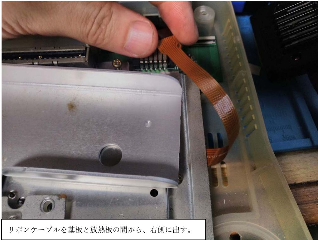
リボンケーブルを HDMI 基板に接続する。
