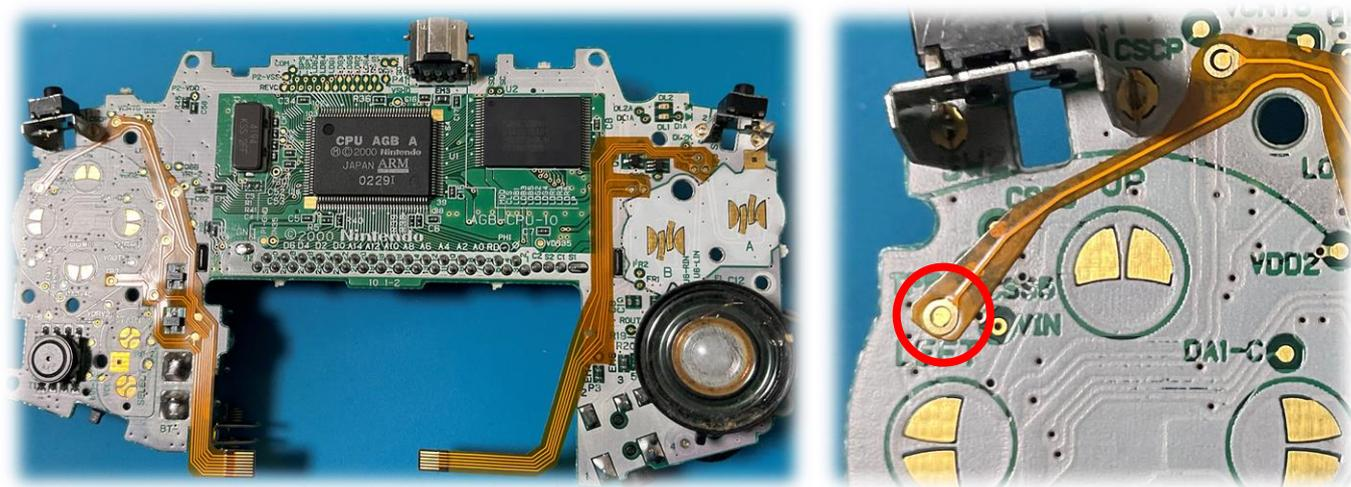
全 12 ヶ所のハンダ付けをします。フレキシブルケーブルは過熱しすぎるとランドが剥がれるので気を付けましょう。
