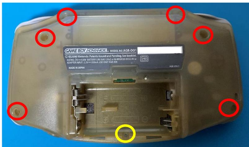
1. 背面ネジ 6 本を Y 字ドライバーで、電池ボックス内のネジ 1 本をプラスドライバーで外します。
