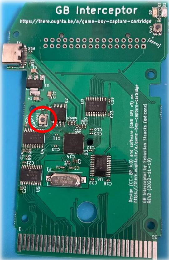
ケース内部、左側中央付近のボタンを押しながら USB ケーブルを挿す事で、パソコンにストレージデバイスとして認識されます。UF2 ファイルをドラッグアンドドロップしましょう。
