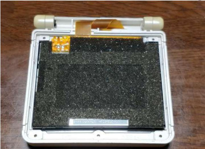
FFC を抜き液晶を取り外します。
