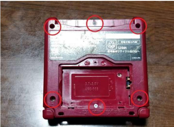
赤丸 Y 字ネジを全て外します。ソフト取り出し口とバッテリー側だけ長さが違います。
