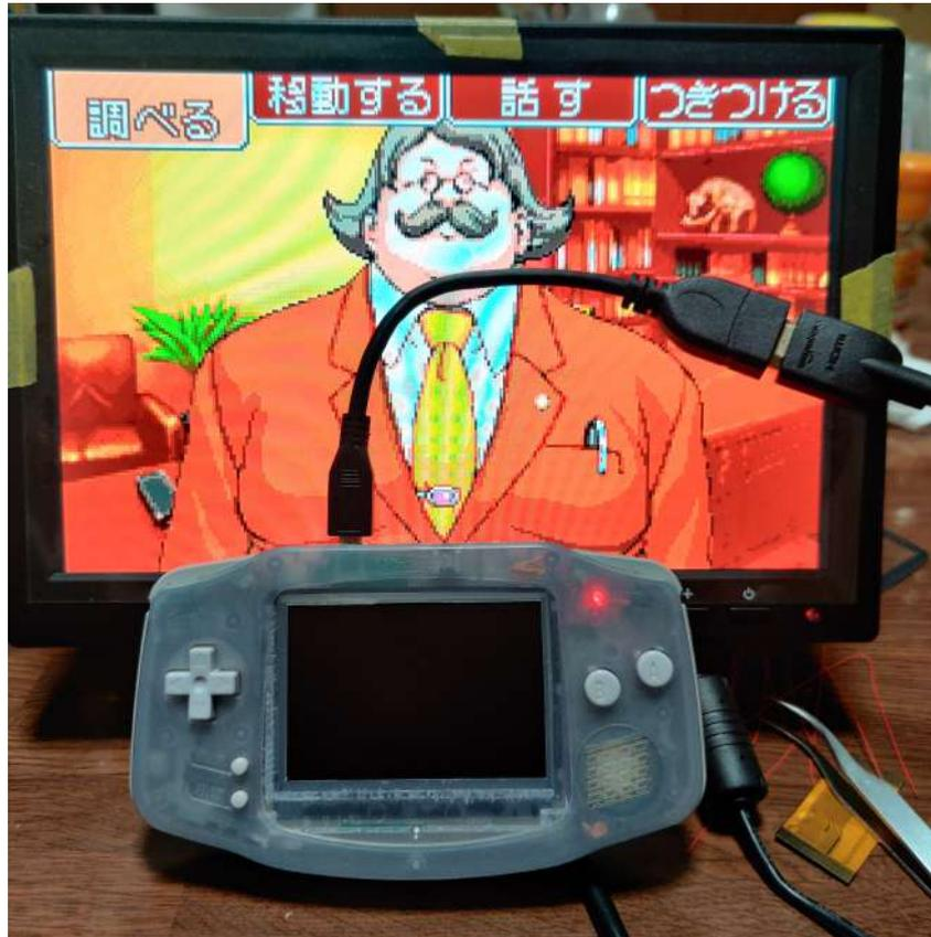
ここでは IPS 液晶 Ver2.0 シェル加工不要モデルを取り付けた GBA に HDMI Kit を取り付けた方法を記載します
