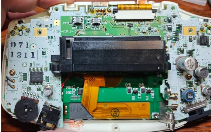
最後に液晶のフィルムが上から出ているのでそれも接続すればあとは組み立てて完了です
