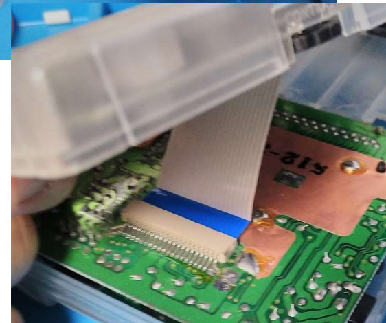
操作基盤とゲームボーイの基盤をつなぐ、フラットケーブル
