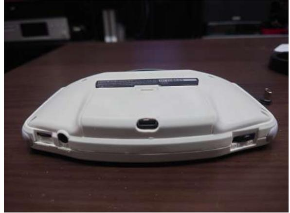
電池カバーの加工は透明のシェルなら、解りやすいのですが加工位置はカバーの横幅 60mm なので、30mm の位置で上から 2.5mm、下から 7mm がこちらの機体での USB の中心でした。そこから、上下 1.5mm、左右 2.5mm で上の加工位置になります。
