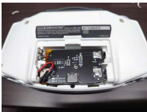
メインの基盤を左側電池の端子に合わせてはめ込みます。
