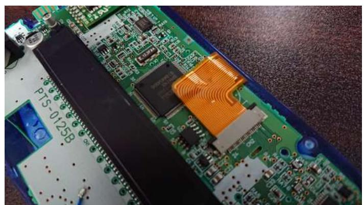
ので、少しシェルをフラットケーブルを噛まないように加工してみました。(赤枠部分) 透明のシェルだとカット部分がカ一トリッジが刺さってないと目立ちますので注意を。
