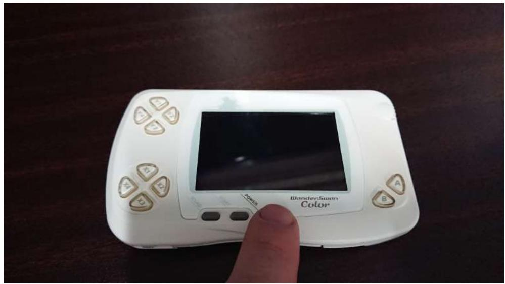
んんっ、起動しない・・・ソフトも入っているし、電池が弱いと起動しないとかも考え、充電池からアルカリ乾電池を新品に替えたけどやはり起動しない。バックライトのLEDがチカチカ点滅をして、ワンダースwanの起動音がリセットを繰り返して鳴っている状態でした。うーん、何かおかしいと思いここで止めて置けばいいのに、素人考えながら配線の断線かと考え液晶裏側の保護スポンジをめくって、3本のコードを自前のコードに付け替えましたが、動作は変わらずでした。
