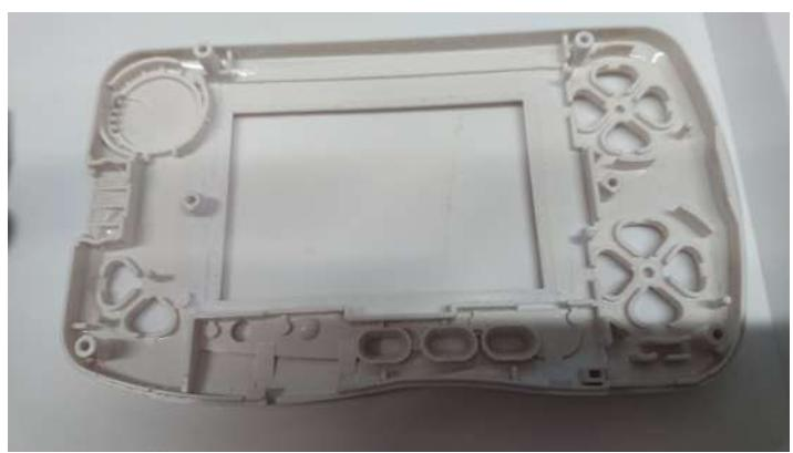
シェルを取り基盤の取り出し、前面シェルを加工して説明どおりに慎重にカット、削っていきます。
