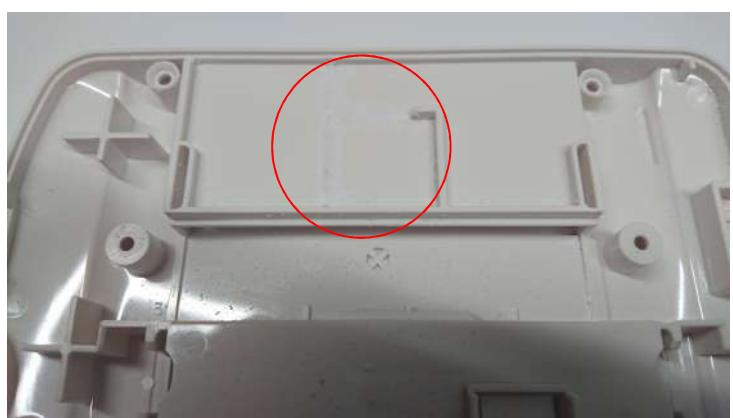
さらに電池ボックス裏側の部分の配線も気になるので、シェルを削っています。(赤枠) コレも透明シェルだと目立ちますので注意です。
