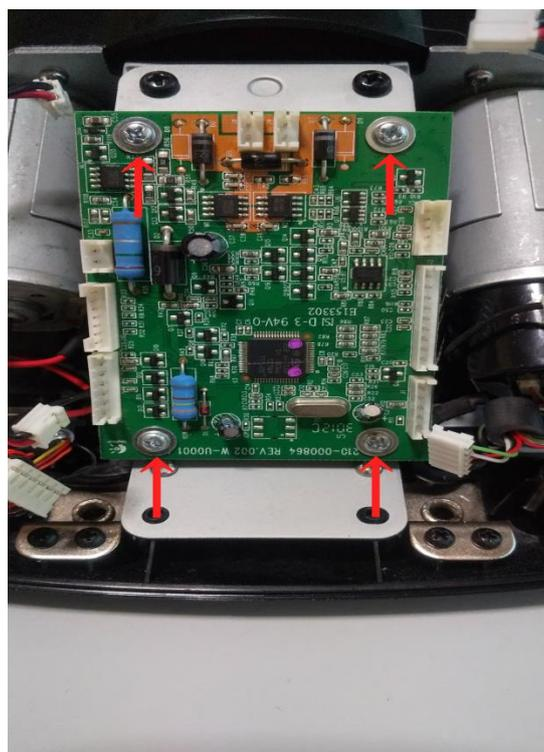
矢印部分のビス4本を外し、基板を外します。(＋ドライバーNO2使用)
