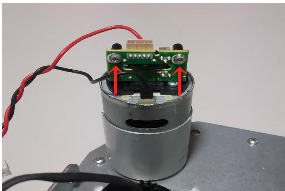
矢印部分のビス2本を外して基板を外します。(＋ドライバーNO1使用)
