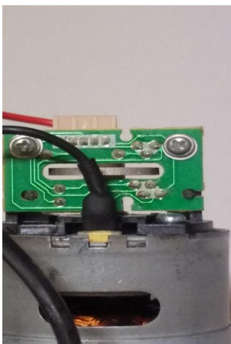
基板を取り付けてエンコーダと接触しないか確認します。
