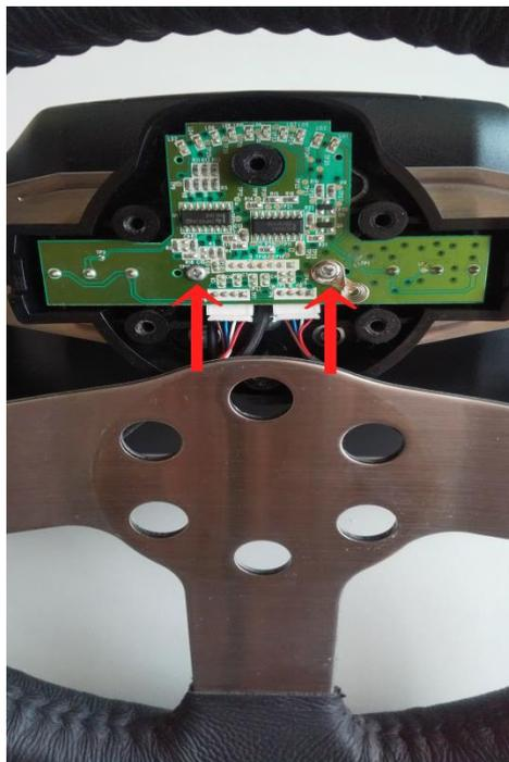
矢印部分のビスを2本外して基板を外します (+ドライバーNO1使用)
