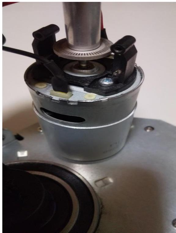
内径 6 mm のパイプを使用して圧入します。
