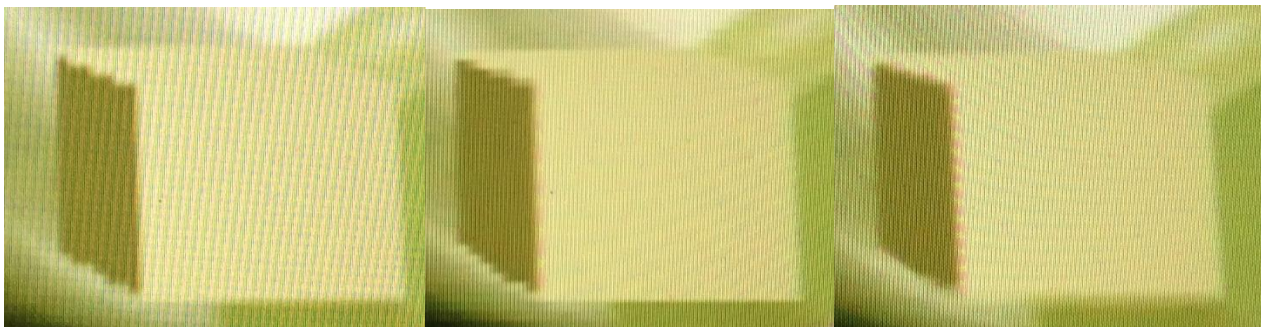
セガサターン S 端子出力、(左)フィルターなし(中央)2xモード(右)FIL モード
