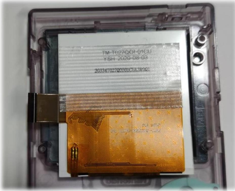
写真の通りに接続されていることを確認する。この時に配線を切らないように注意する。
