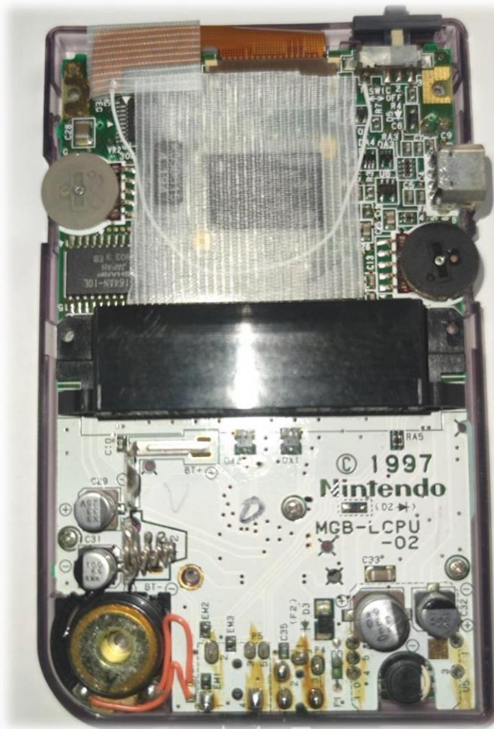
アンテナケーブルを折り曲げて、外装につくように曲げる。
