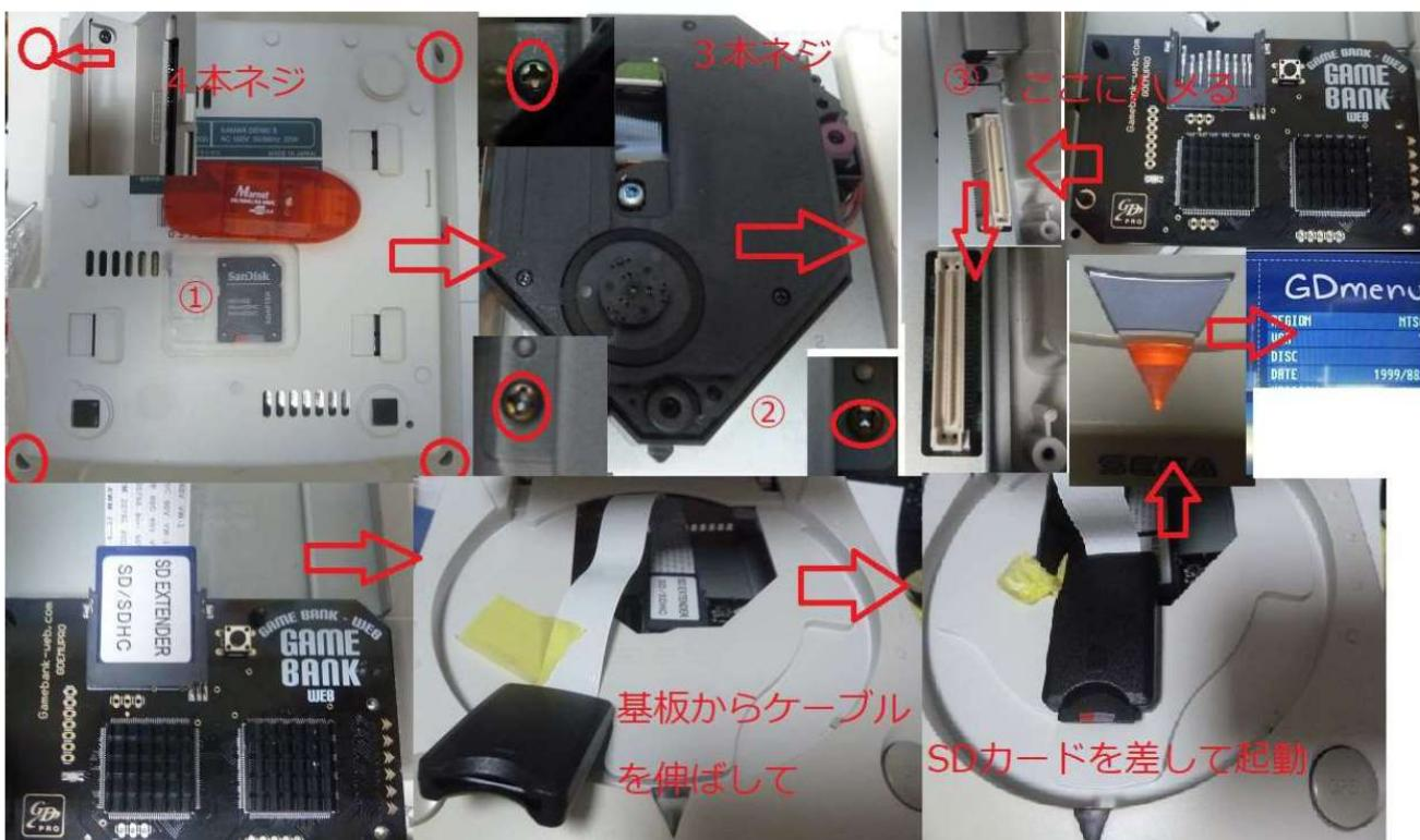
①本体裏ネジを外し②上面蓋を外しGDドライブのネジをとれば③のコネクタに
